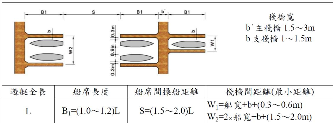
圖 16 浮動碼頭繫泊設施諸元尺寸圖<sup>5</sup>
