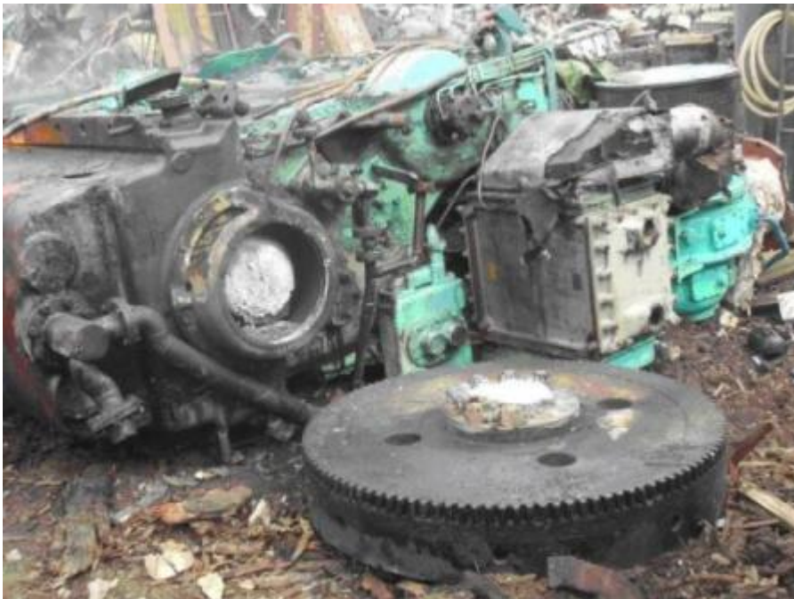
主機引擎曲軸切斷後
