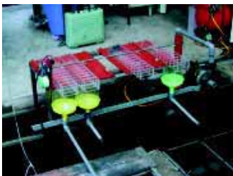
循環水道式立體化養蝦系統噴射式定量投餌機
